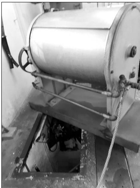
4. kép: Az ipari mosógép és az alatta található lejárát (Forrás: A szerző saját felvétele)
