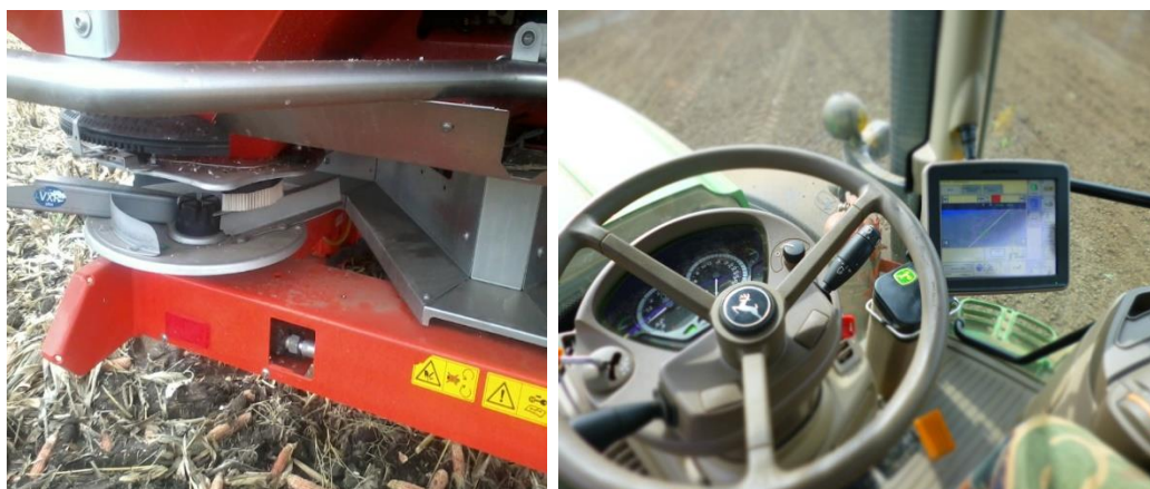
4. ábra. Beállítások a szóró tányéron. A beállított értékek a traktorban lévő monitoron
