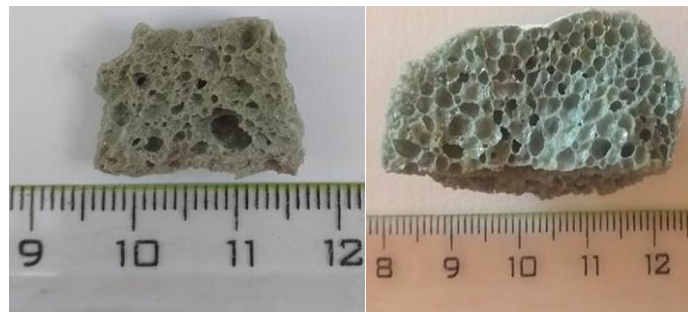
1. ábra. Dolomit (bal) és szilícium-karbid (jobb) által habosított üveghab tabletták
