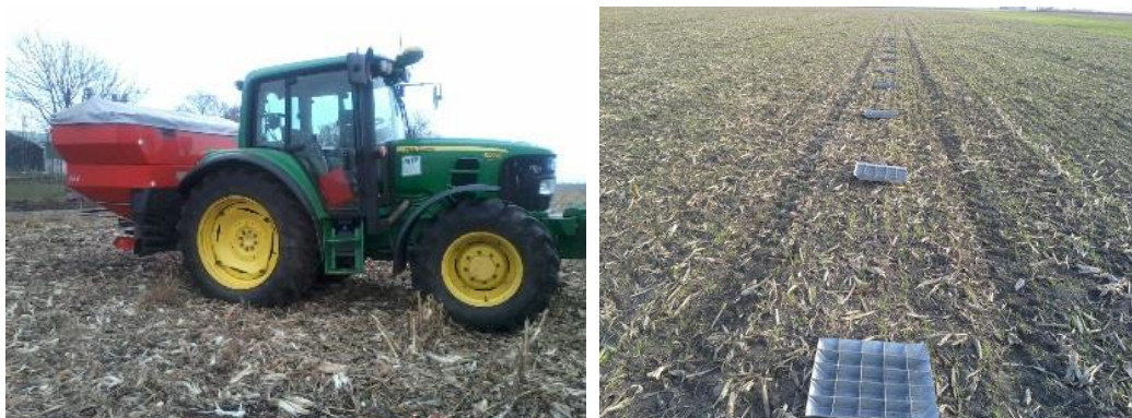
1. ábra. John Deere 6320 erőgép, Rauch AxisH 2 tárcsás műtrágyaszóró gép, hidraulikus hajtással. A mérőtálcák a parcellán
