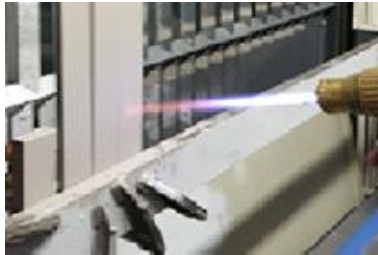
2. ábra. Próbatestek készítése nagysebességű láng-porszórással
