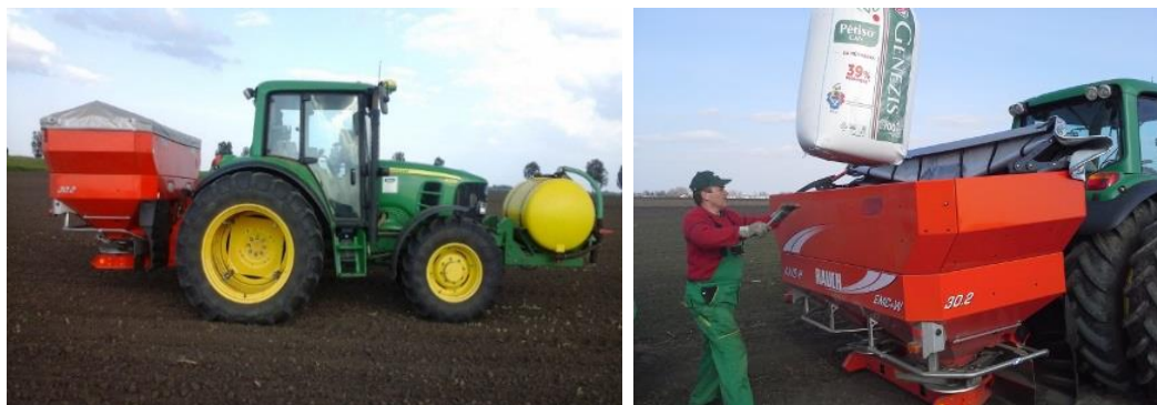
3. ábra. John Deere 6230 erőgép és RAUCH AXIS H műtrágyaszóró munkagép. A műtrágya betöltése.
