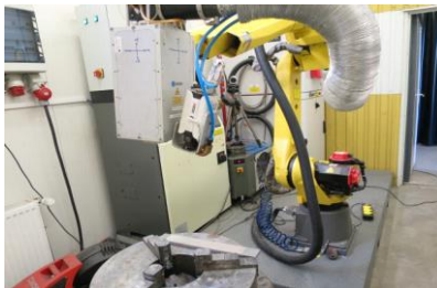
3. ábra. A szórt réteg újraolvasztása Fanuc robotra szerelt kevert diódalézer hőforrással
