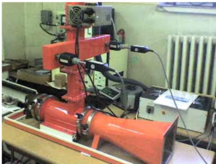
1. ábra. Aktív szén mikrohullámú besugárzó és mérő berendezés
