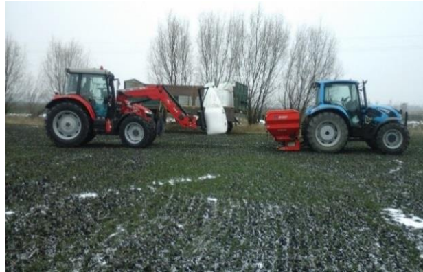
2. ábra. Traktor Landini 5 – 110 H; Munkagép: RAUCH MDS 935 műtrágyaszóró + deflektor
