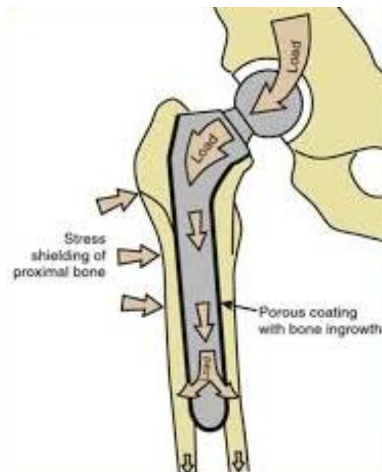
1. ábra. Csípőimplantátum beépítési vázlata [1]
