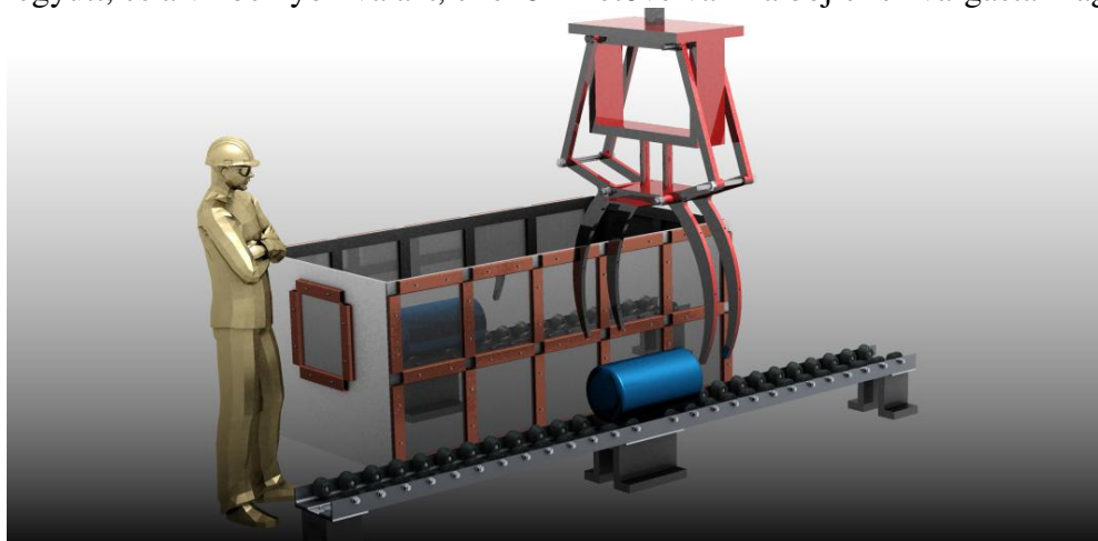
10. ábra. A megfogó szerkezet a bojler felett
