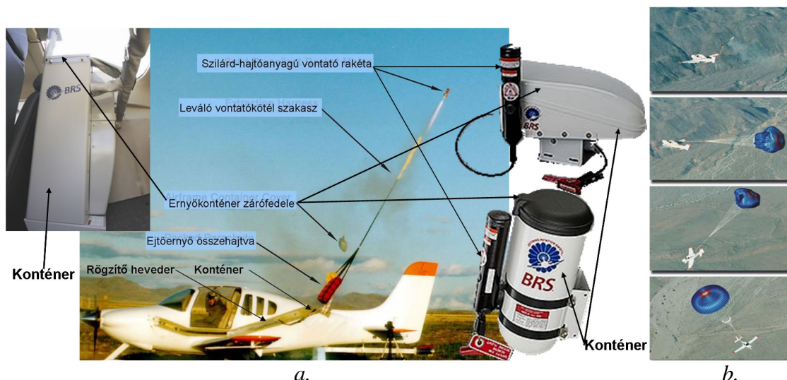
7. ábra Repülőgép mentőernyő lehetséges kialakítása, elhelyezése és működési folyamata [4]
