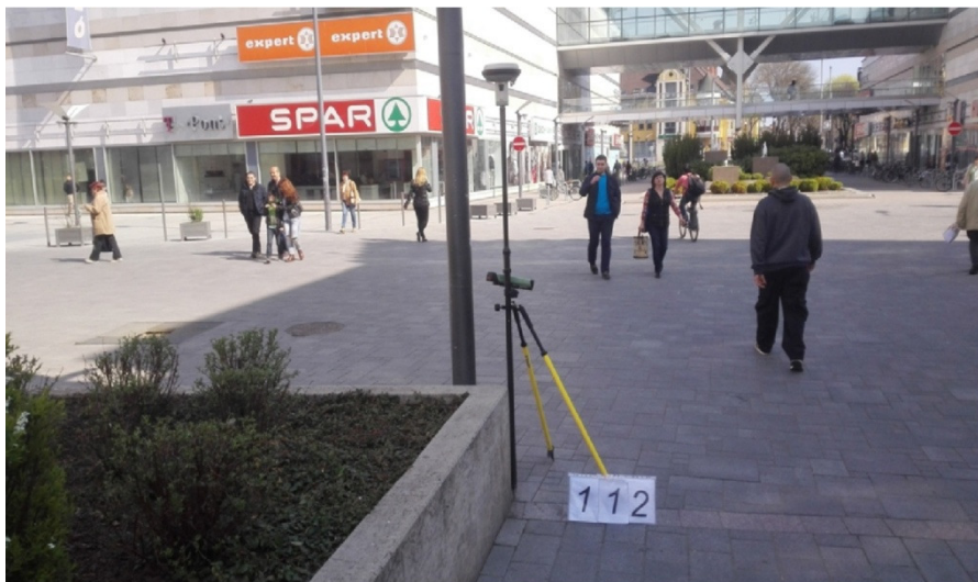
4. ábra. I. rendű (112-es) referencia pont terepi meghatározása.
