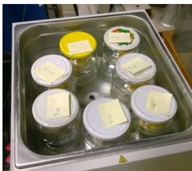
4. ábra. Állandó hőmérsékleten tartás termosztáttal ellátott készülékben
