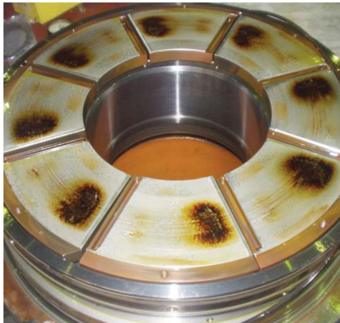
1. ábra. Siklócsapágy károsodás (kenőanyag túlhevülés) [2]
