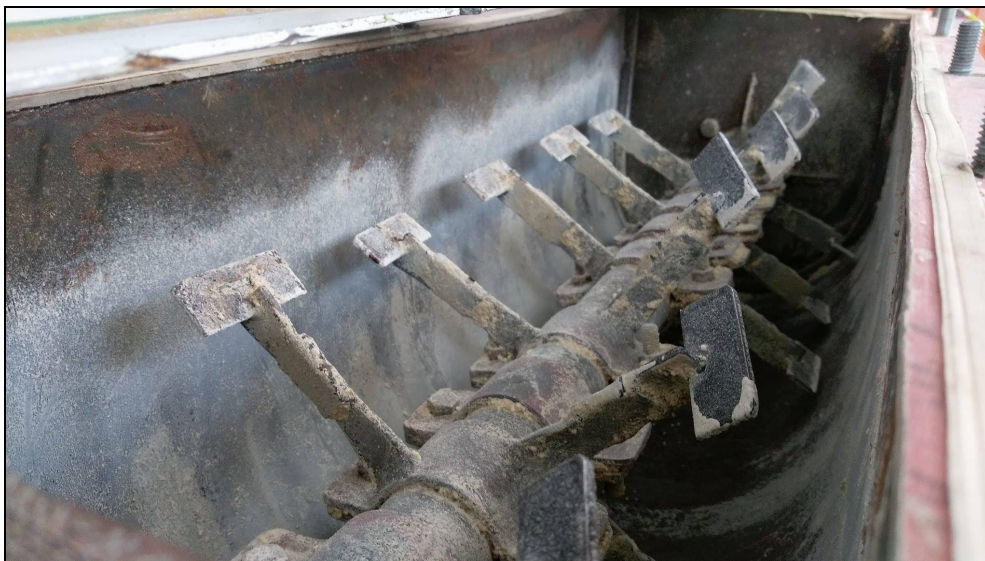
1. ábra. Keverős dobszárító horizontális tartálya keverőlapáttal
