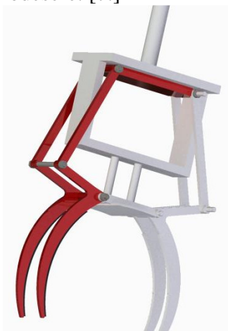
7. ábra. A szerkezet kényszerkapcsolatát biztosító elemek
