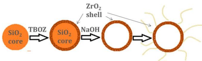
1.ábra: Szilícium dioxid sablonon leválasztott cirkónium dioxid nanorészecskék előállításának és funkcionálisításának sematikus ábrája
