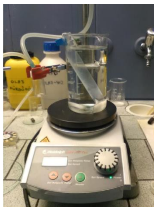
2.ábra: A szilika mag kioldása féligáteresztő hártya segítségével lúgos körülmények között
