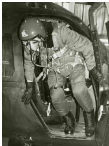
4. ábra. Ka-60 típusú helikopter vészelhagyása földön (forrás: a Szerző gyűjteményéből, eredete ismeretlen)
