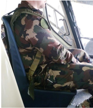
2. ábra. ATL-88/98-S-1 típusú ülő pilóta mentőejtőernyő elhelyezése AS-350B típusú helikopterben (forrás: Németh Endre mk. fhdy., Budaörs, 2016.02.02.)
