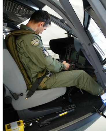
3. ábra. ATL-88/90-1 típusú háti pilóta mentőejtőernyő elhelyezése H145M típusú helikopterben (forrás: a Szerző felvétele, MH 86. SZHB, 2020.04.28.)
