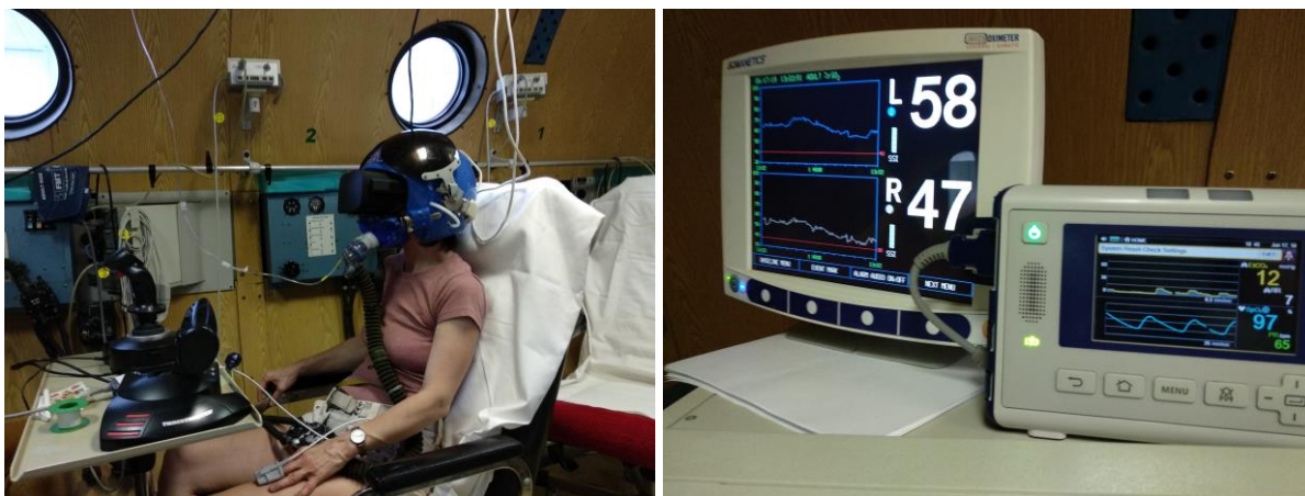
1. ábra A tesztlabor a VR rendszerrel, valamint a NIRS és a Kapnográf műszerek mérés közben.
