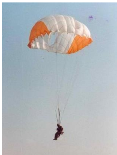
6. ábra. Sz-4U típusú pilóta mentőernyő légialkalmassági vizsgálata [4]
