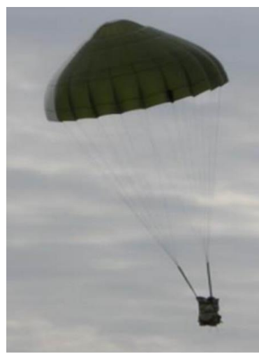
7. ábra. ATL-88/98-S-1 típusú pilóta mentőejtőernyő ún. „bábús bedobása” (forrás: a Szerző felvétele, 2014.08.25.)
