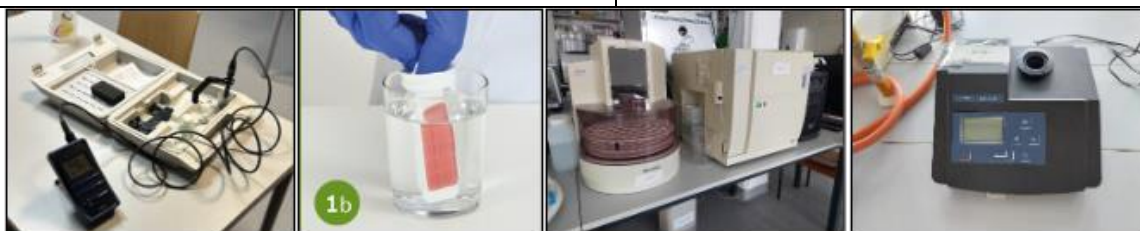
2. ábra. a. Hordozható WTW Multi 3320 pH és vezetőképesség mérő készülék, b. HygieneChek™ PLUS Dip-Slides gyorseszteszt, c. Shimadzu TOC-Vcpn készülék, d. WTW Turb 555 IR – fényszórás fotométer, zavarosságmérő
