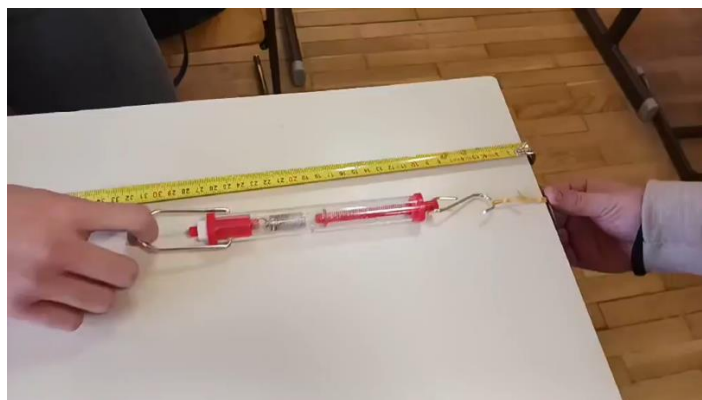
8. ábra: Diákok mérőszalaggal mérik a gumi megnyúlását, a húzóerőt pedig rugós erőmérővel. A folyamatot videóra vették, amiből az összetartozó erő-megnyúlás adatokat rögzíteni tudták
